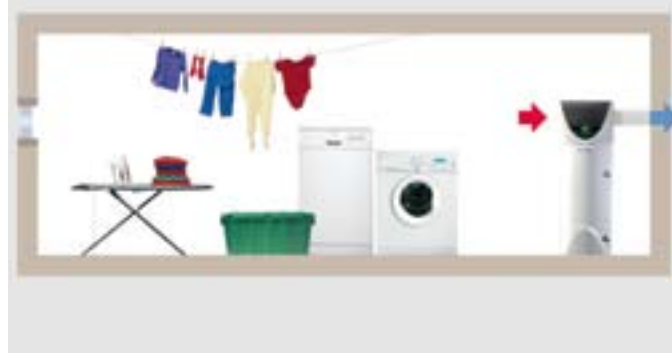
Aspirazione da locale non riscaldato*
